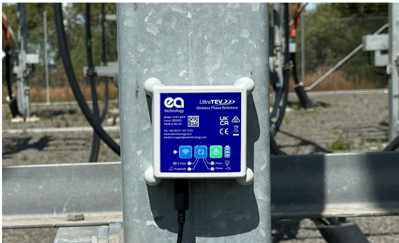
现场使用无线相位参考的实例。
